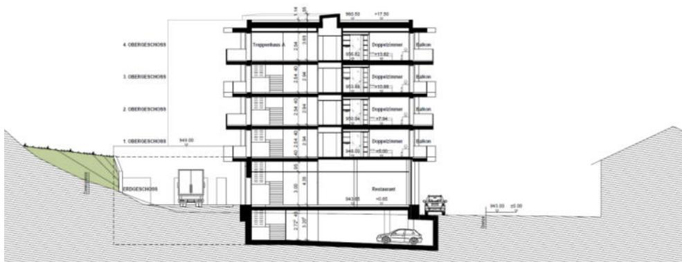
Abbildung 3: Schnitt durch das geplante Gebäude [2]. Blickrichtung Südosten. Nicht massstäbliche Darstellung.
