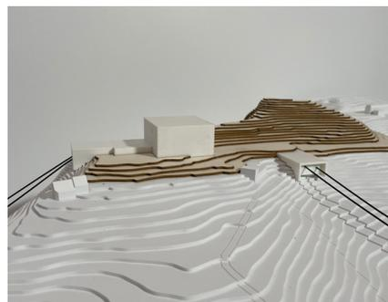
Das Berghaus ist in dieser Variante als einziges vollständig oberirdisches Gebäude sichtbar (ca. 8 m, 2-geschossig). Die Absenkung der Gebäude (unterirdische Stationsgebäude) hat einen grossen Eingriff in den Felsen zur Folge.
