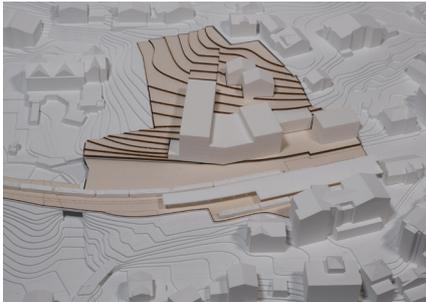
In dieser Variante übernimmt das Hauptvolumen mit einer Abwinklung des Gebäudes den Verlauf der Strasse und des natürlichen Hangs. Der Einschnitt zwischen dem Auftaktgebäude mit öffentlicher Nutzung und dem Stationsgebäude mit Nebennutzungen schafft eine Platzsituation, welche den bestehenden Bahnhofplatz erweitert und die Gäste vom Bahnhof her aufnimmt. Die Nutzungen um die Platzsituation sollen möglichst publikumsorientiert sein.
